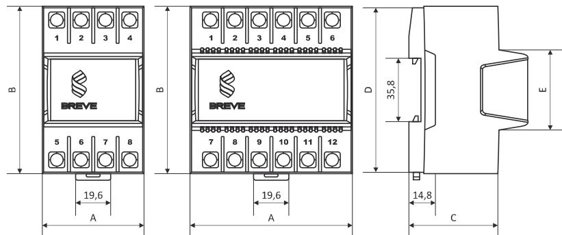
Moc | Power | Leistung | Мощность: **20; 30; 60; 100W**Zakres napięcia PRI | Rated voltage PRI | Spannung PRI | Диапазон напряжения PRI: **110 - 230V 50/60Hz**
