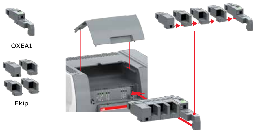
Rys. 9.6 Montaż modułu zasilania pomocniczego OXE1 i modułów Ekip
