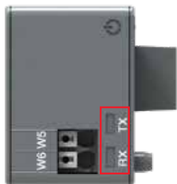
Rys. 5.15 Sygnalizacja modułu Ekip Com Profibus DP
